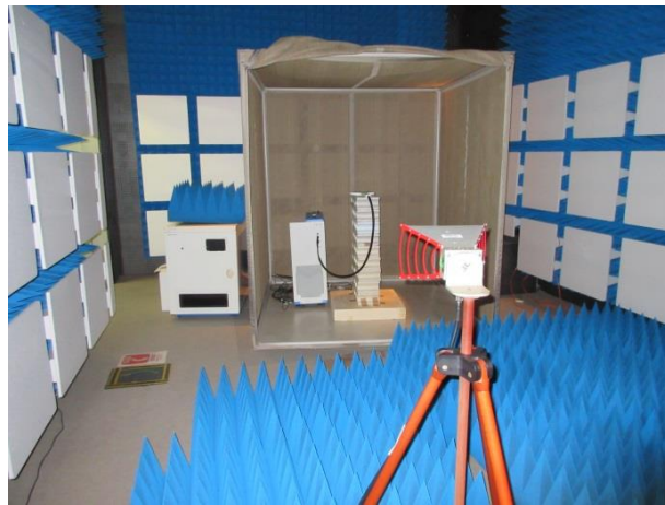
図 2 検出装置誤動作試験系の概観
