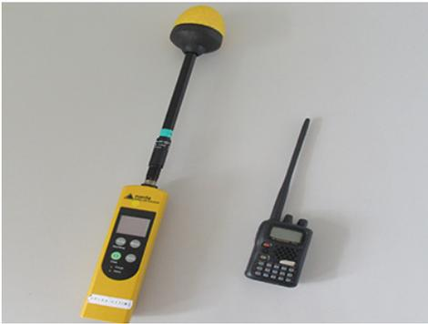
NBM-520 型 高周波電磁界測定器（測定範囲：100kHz から 60GHz）とトランシーバーを使用し、測定器とトランシーバーを 5cm、10cm 離れた距離で電界強度を測定し、遮蔽性能を確認しました。
